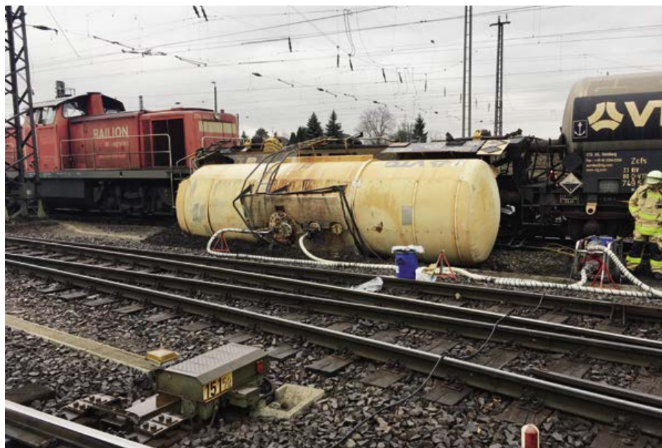
Kesselwagen mit aufgebauter Förderstrecke während des Umfüllvorgangs.
