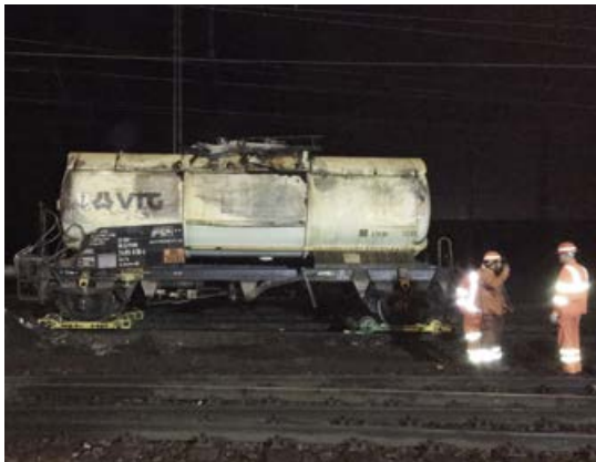
Kesselwagen nach der Bergung auf den Hilfsdrehgestellen.
