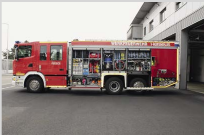
SLF_Geräteraum links (2) G1 oben Auffangwanne, mittig Düsenschläuche, G3 Lüfter mit Verbrennungsmotor; G5 Bedienplatz Maschinist mit G6.
