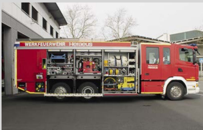
SLF_Geräteraum rechts (3) G2 oben Sprungpolster, unten Stromerzeuger und Lüfter mit Elektromotor, G4 HALE Mini-CAFSs, G6 Bedienplatz Maschinist mit G5.
