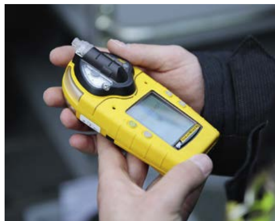
Messung der Konzentration des ausgeströmten Gases mit verschiedenen Gasmessgeräten.
