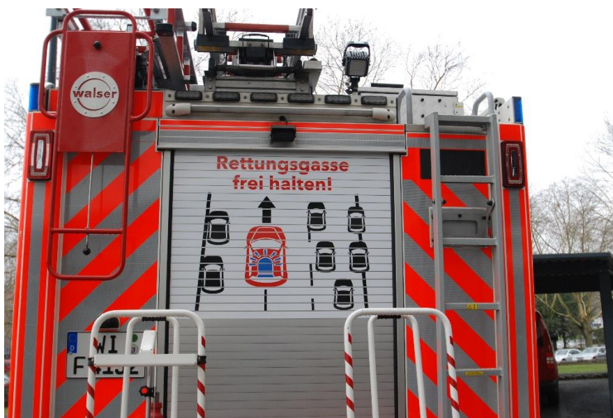
Abb. 1: Beispiel für die korrekte Ausführung und Anbringung der Beklebung
